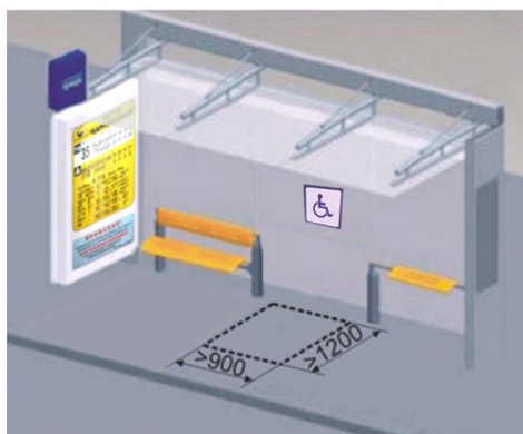
Рисунок 49 – Примеры обустройства павильонов, доступных для инвалидов
