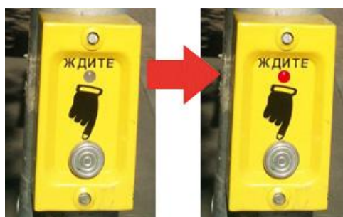
Рисунок 41 – Пример работы светового индикатора на блоке вызывного устройства
