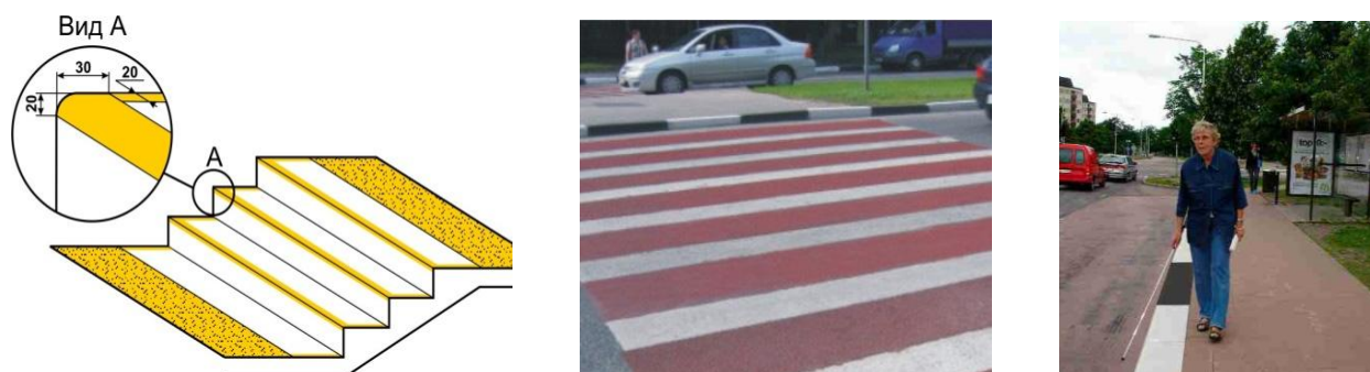
Рисунок 72 – Примеры выполнения контрастных покрытий
