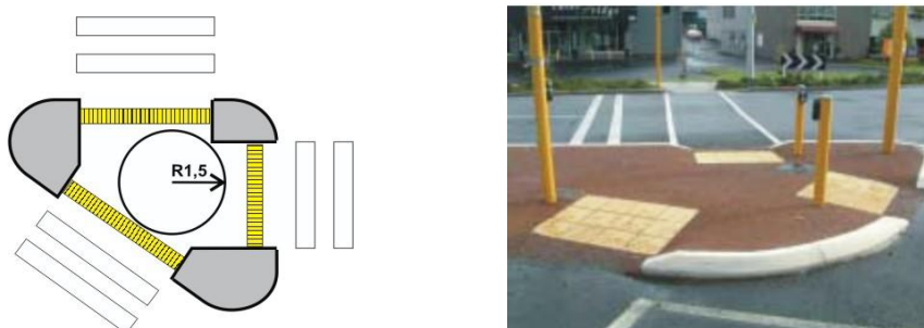
Рисунок 36 – Пример обеспечения доступности островка безопасности для людей в кресле-коляске и других маломобильных групп населения
