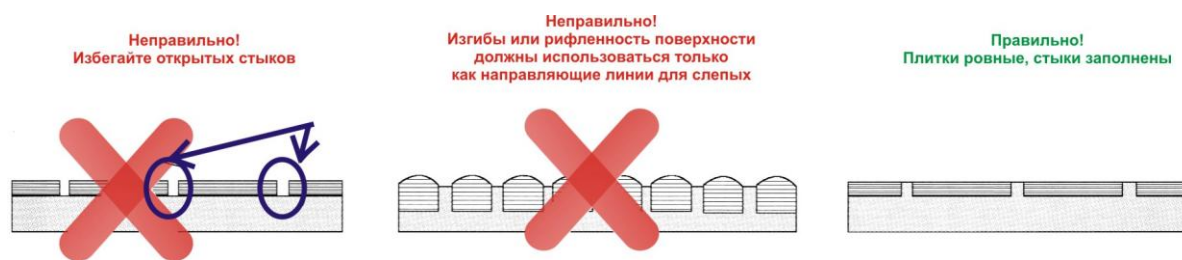
Рисунок 1 – Неправильная и правильная формы поверхности покрытия пешеходной части элементов обустройства автомобильных дорог
